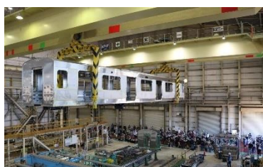
車体のクレーン移動
