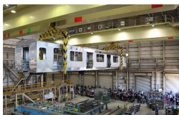
車体のクレーン移動
