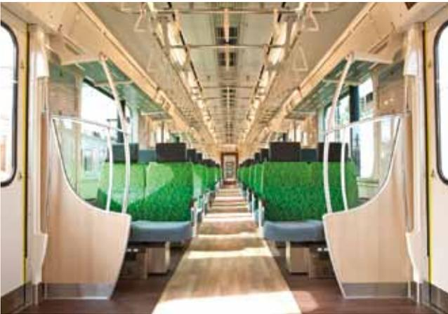
図3 ロング／クロス転換腰掛搭載車 室内
