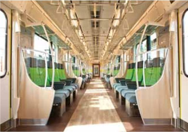
図2 ロング／クロス転換腰掛搭載車 室内
