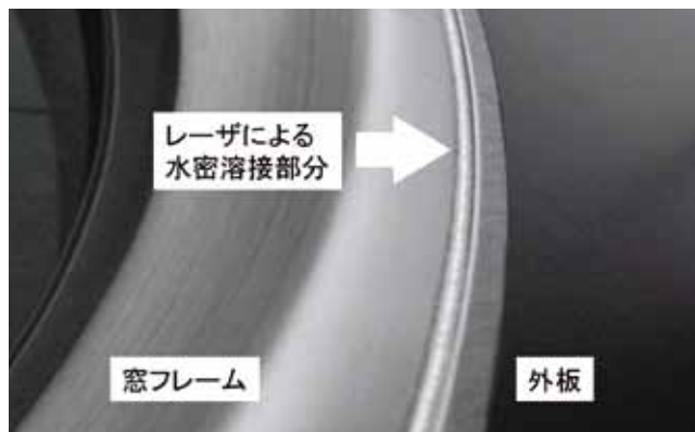
図16 窓フレームと外板の水密溶接部位
