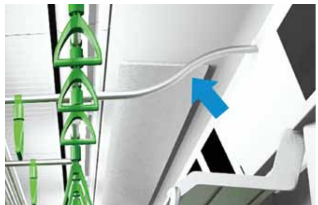
図 14 新開発した内装ロールバーの概要図
