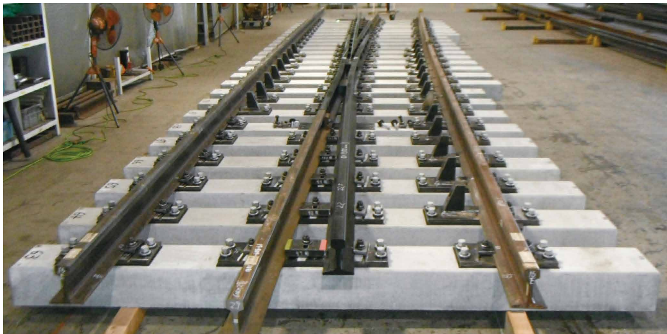
図1 製品組立状態（和歌山事業所内での仮組立状態）
