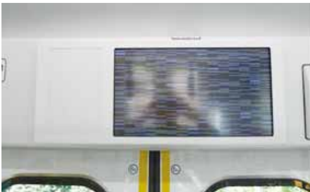
図 12 不具合発生時の状況 (1)
