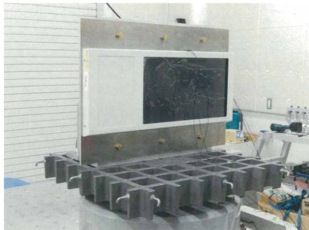
図6 型式試験の様子(振動試験) (1)
