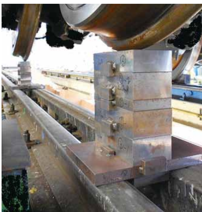
図3 車輪持ち上げ高さの設定
