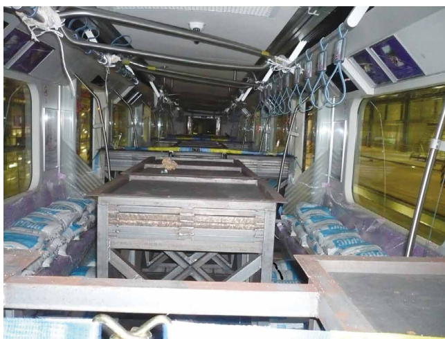
図2 定置試験における満員荷重積載
