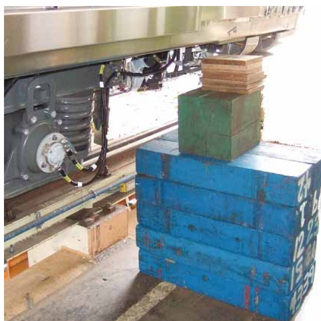
図5 車体の転倒防止策
