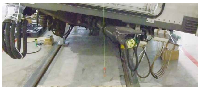
図4 車体重心位置から重錘の吊り下げ
