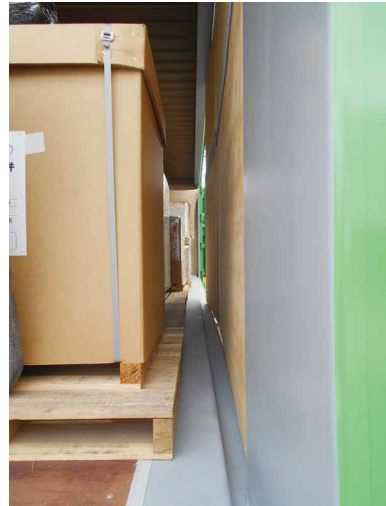
図 13 試験輸送 輸送品とコンテナ側面 (内面) とのクリアランス
