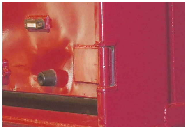
図9 溶接による外板とヒンジの接合
