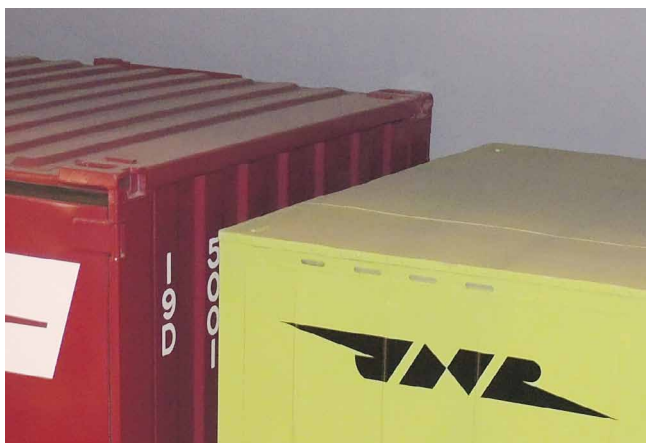
図8 コルゲーション板の有無 (左側19D形は屋根と妻面がコルゲーション板を使用)
