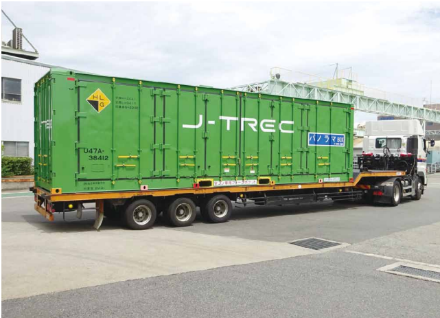
図7 トレーラに搭載した31フィートコンテナ
