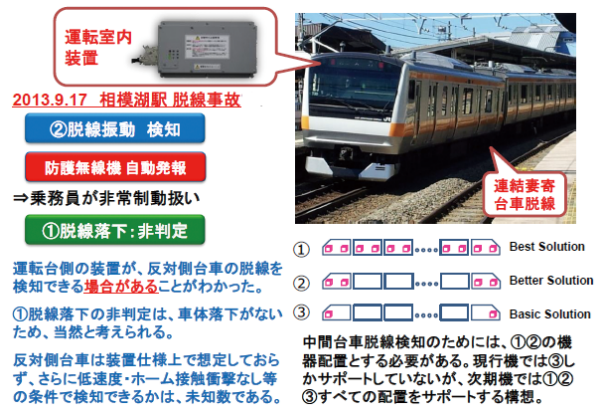
図8 実際の事故における検知動作 (相模湖駅脱線) (7)
