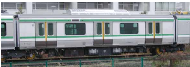
図 22 世界初のレーザーによる車両構体
