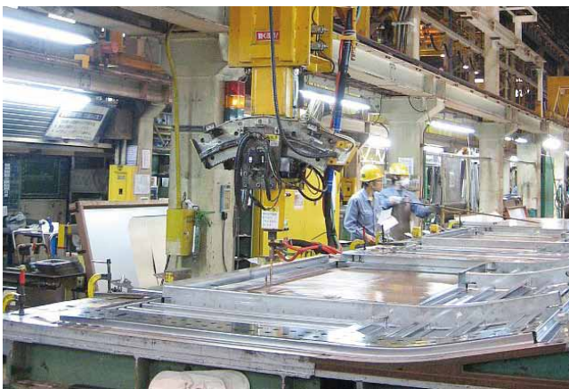
図11 側ブロックの自動溶接機
