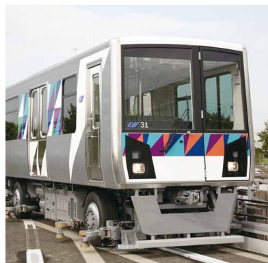
図 23 レーザスポット溶接とレーザー突合せ溶接を採用した横浜シーサイドライン 2000 型 (11)
