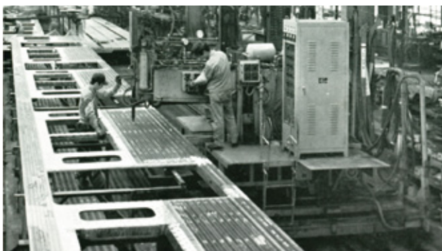
図3 帝国車輛での側構スポット溶接作業 (9)
