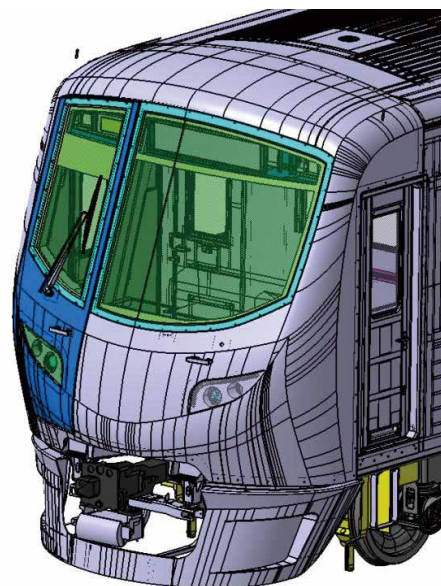
図7 3Dによる先頭部設計の例
