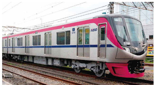
図2 フルフラット構造 sustina 量産車 (京王電鉄5000系)
