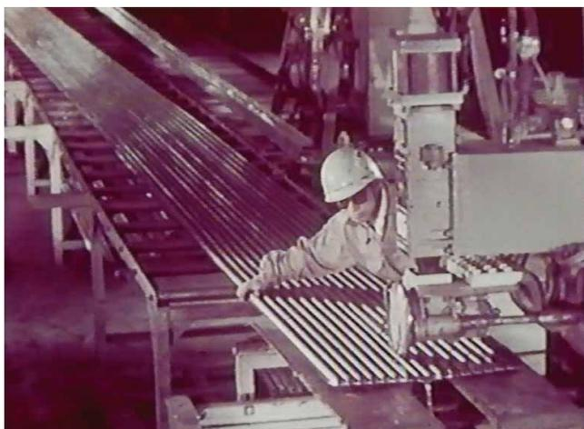
図7 屋根板のシーム溶接<sup>(3)</sup>
