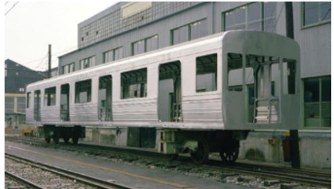
図11 軽量ステンレス試作構体<sup>(2)</sup>
