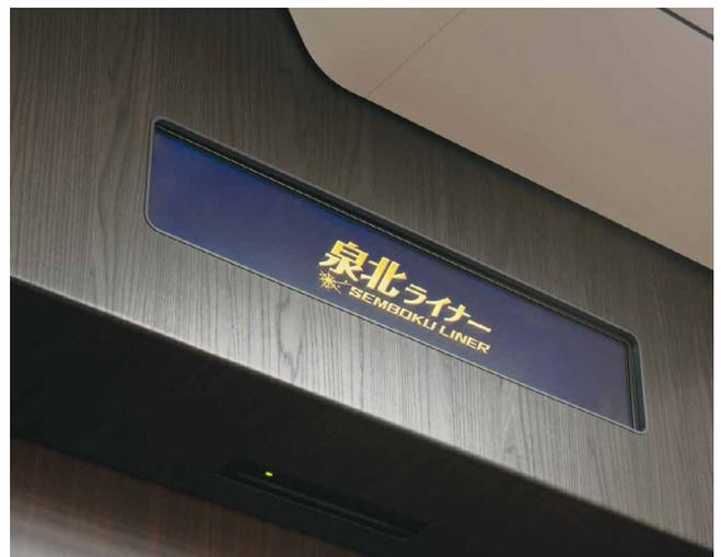
図10 液晶ディスプレイ式車内案内表示装置
