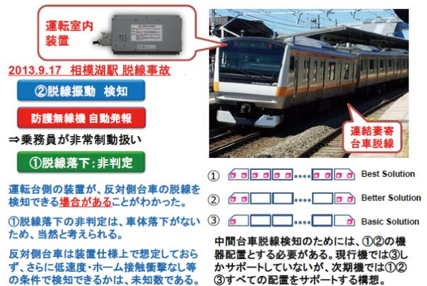
図8 実際の事故における検知動作（相模湖駅脱線）<sup>(7)</sup>
