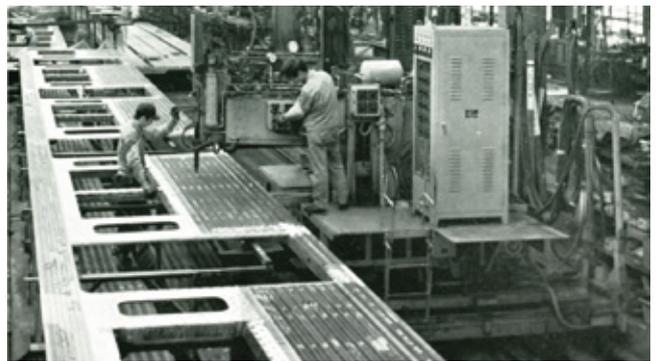
図3 帝国車輛での側構スポット溶接作業<sup>(9)</sup>
