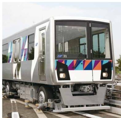
図 23 レーザスポット溶接とレーザー突合せ溶接を採用した横浜シーサイドライン 2000 型<sup>(11)</sup>
