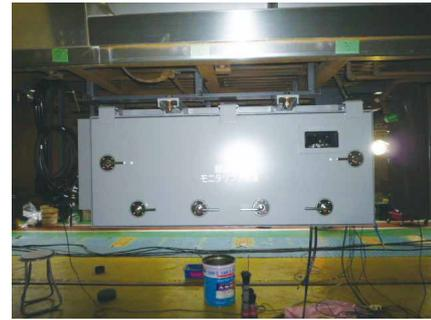
図5 軌道変位測定装置 制御ユニット
