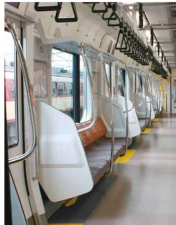
b) 吊手高さのUD化実用例 (JR東日本 E233系)
