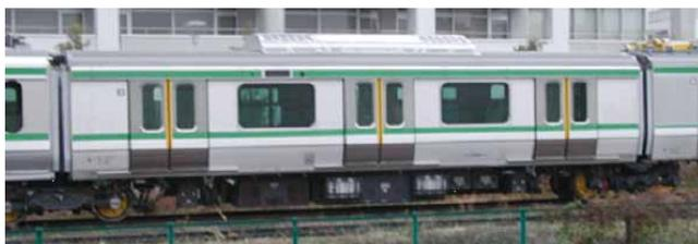
図 22 世界初のレーザーによる車両構体
