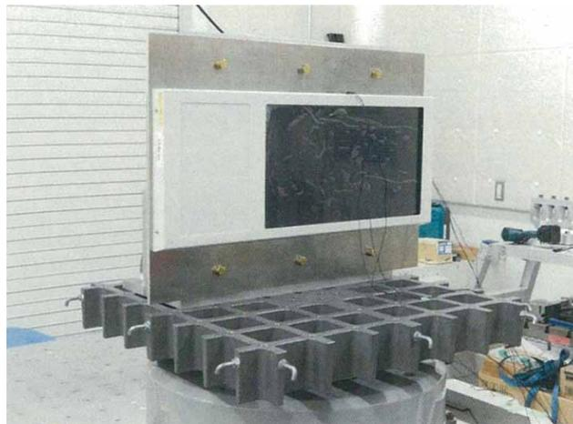
図6 型式試験の様子(振動試験)<sup>(1)</sup>
