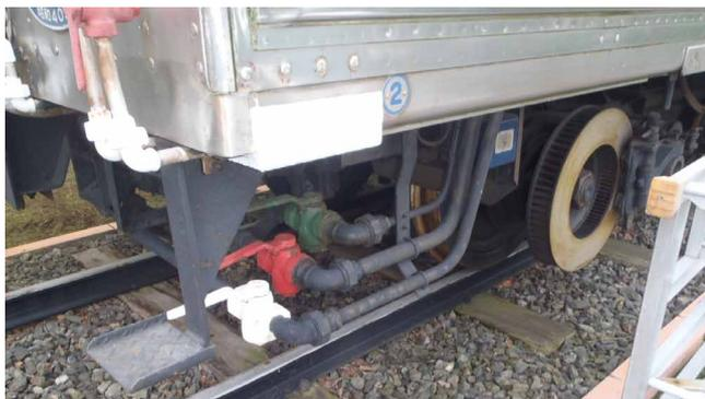
図2 鉄道車両用空気配管とコック類
