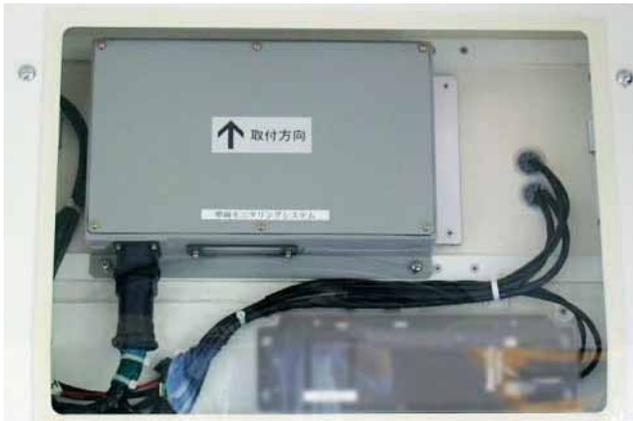
図5 脱線検知装置外観<sup>(4)</sup>
