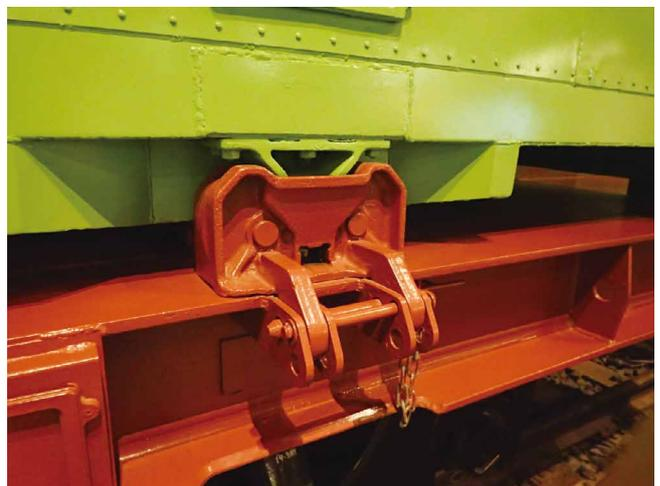
図4 6000形コンテナの緊締装置（拡大）
