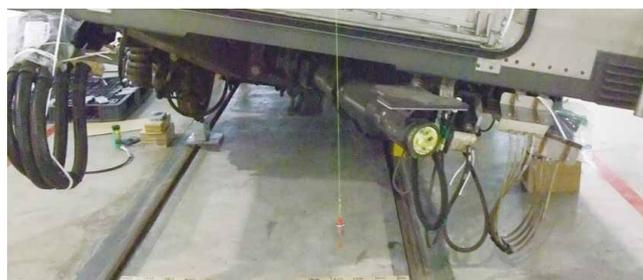
図4 車体重心位置から重錘の吊り下げ
