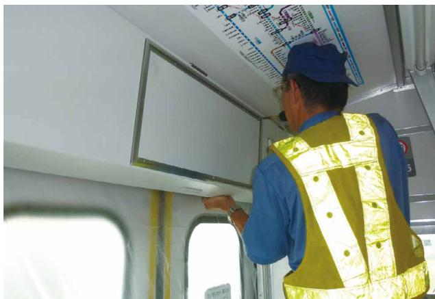
図7 取付作業(広告外し作業)<sup>(1)</sup>
