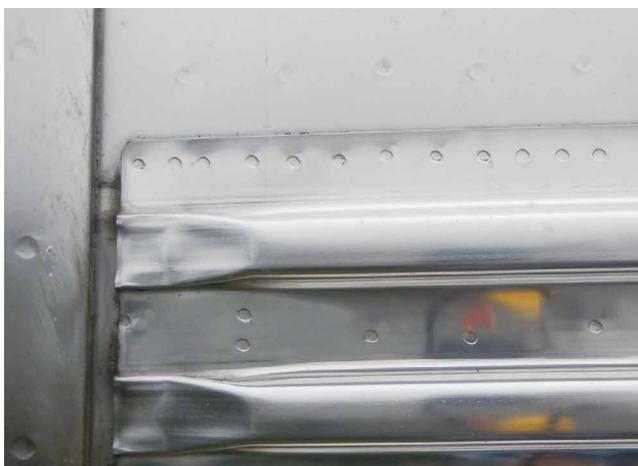
図9 側構体の抵抗スポット溶接の圧痕
