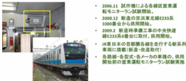
図7 JR東日本向け防護無線自動発報装置普及状況<sup>(9)</sup>
