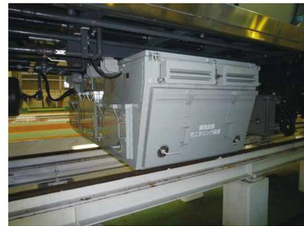
図6 軌道材料モニタリング装置
