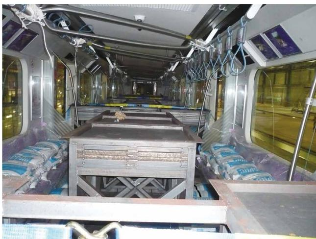
図2 定置試験における満員荷重積載
