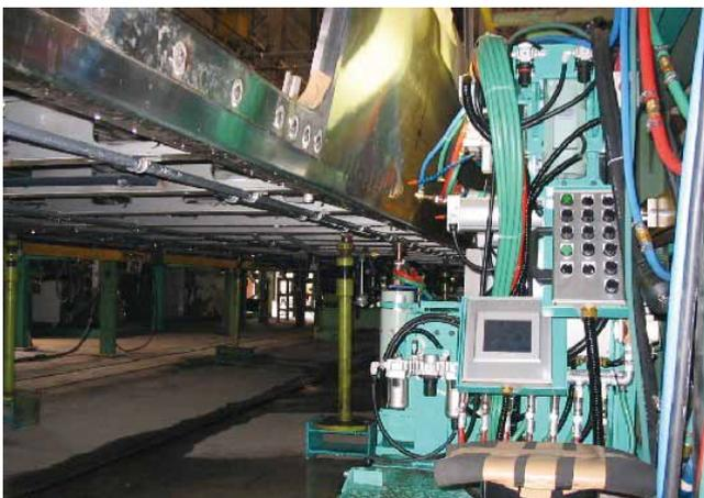
図12 インダイレクトスポット溶接機
