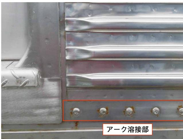
図10 抵抗スポット溶接とアーク溶接
