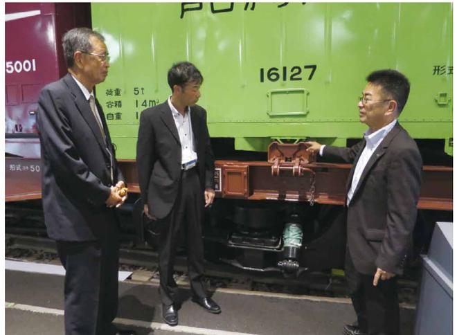
図3 6000形コンテナの緊締装置
