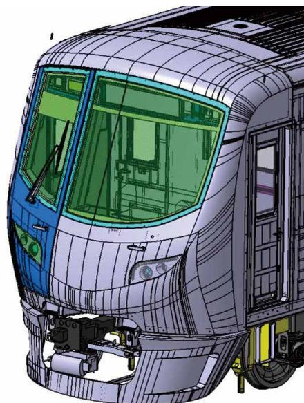
図7 3Dによる先頭部設計の例
