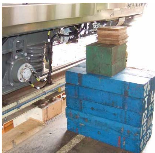
図5 車体の転倒防止策
