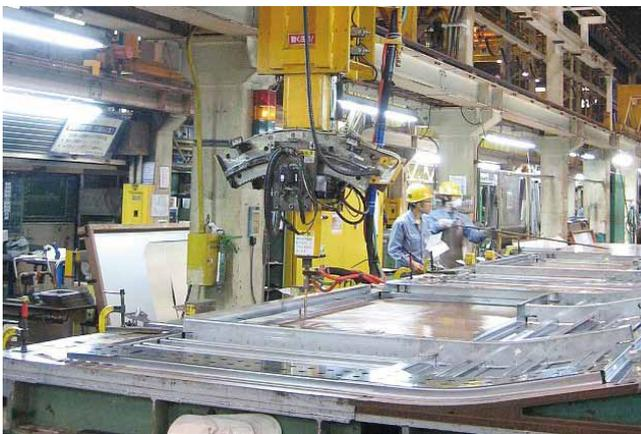
図11 側ブロックの自動溶接機
