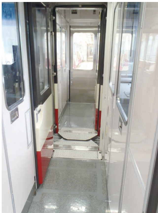
図 3 先頭車連結状態（車内）
