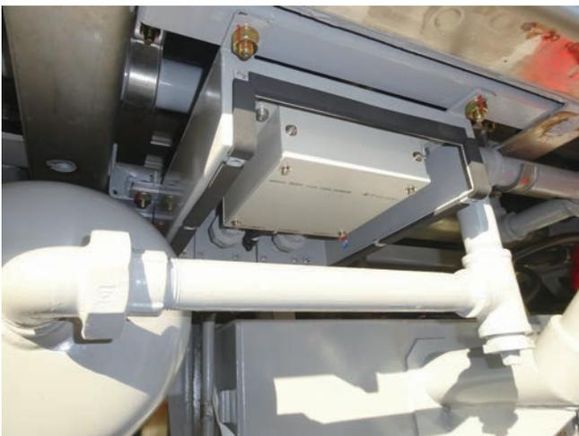
図4 燃料タンク用 燃料漏れ検知センサ<sup>(1)</sup>
