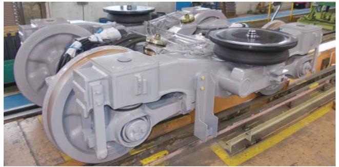
図11 DT75B 電動台車 (中間台車)<sup>(1)</sup>
