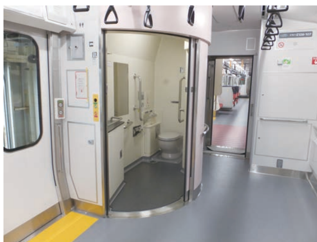
図 7 車いす対応大型洋式便所 (1)
