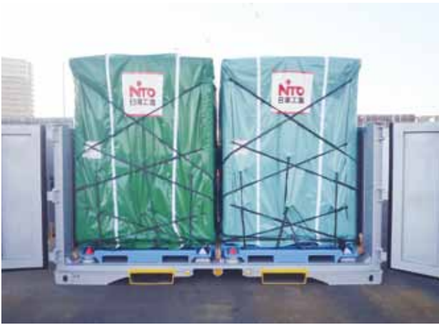
図5 分割型パレットによる積載
