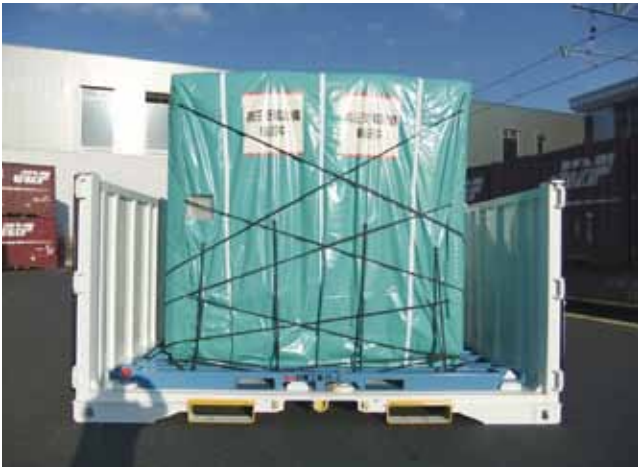
図6 一体型パレットによる積載
