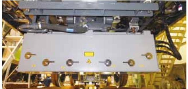
図6 線路モニタリング装置
