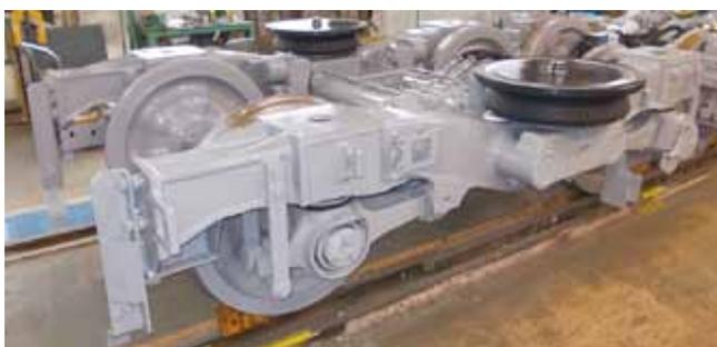
図 14 TR260B 付随台車（先頭台車）
