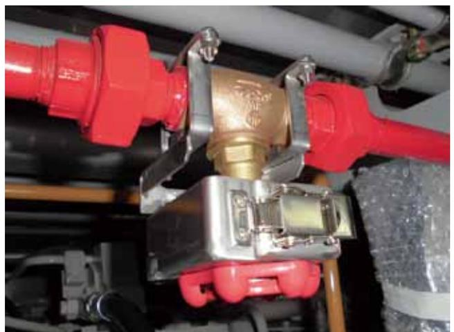
図7 燃料バルブ回り止め金具
