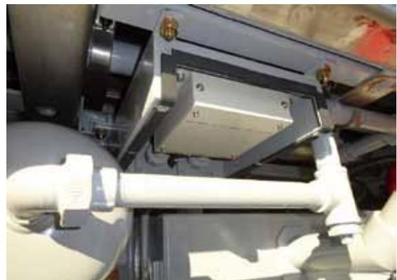
図6 燃料タンク用 燃料漏れ検知センサ
