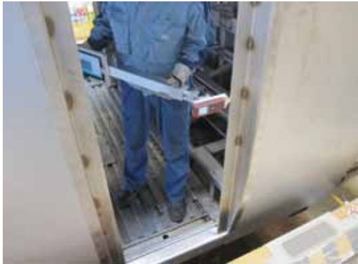
図6 乗務員室出入口幅の測定
