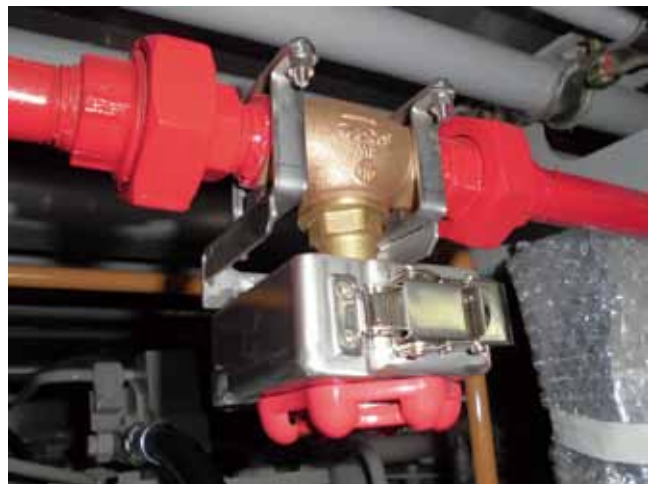
図7 燃料バルブ回り止め金具
