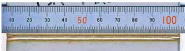
図6 突合せ溶接部撮像画像（元画像）
