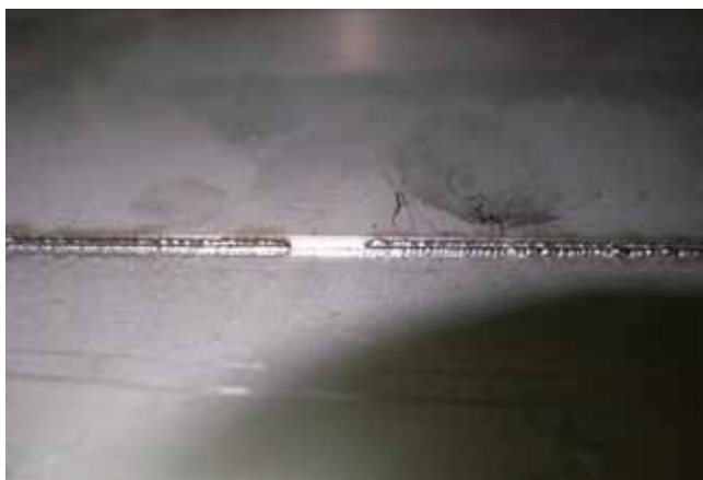
図 11 レーザ水密溶接撮像元画像（未溶接部あり）
