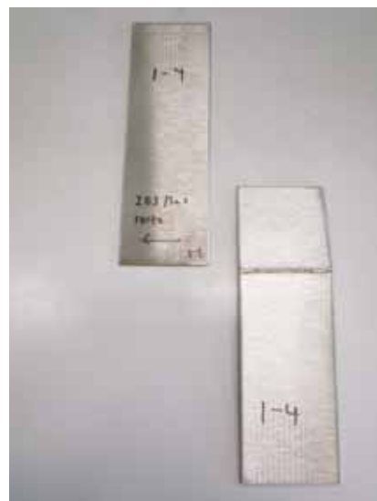
図 15 引張後の試験片外観（20J 継手）
