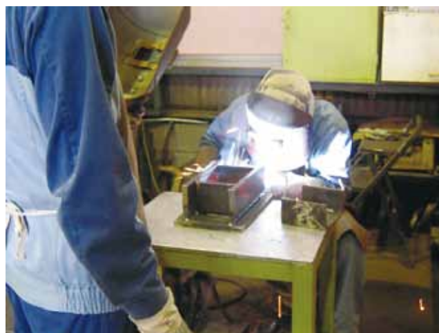
図5 協力会社における溶接試験の例
