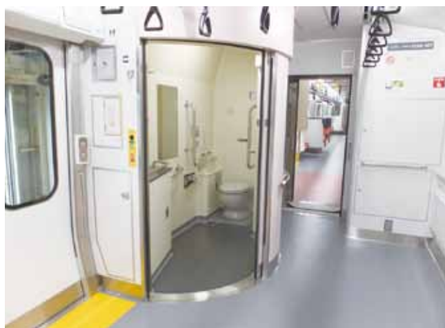
図4 車いす対応大型洋式便所
