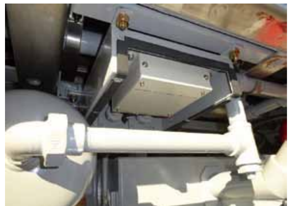
図6 燃料タンク用 燃料漏れ検知センサ
