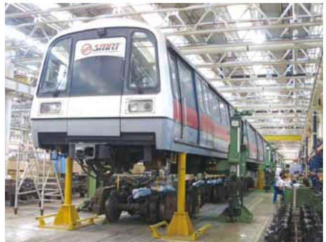
図6 改造工事中のC151
