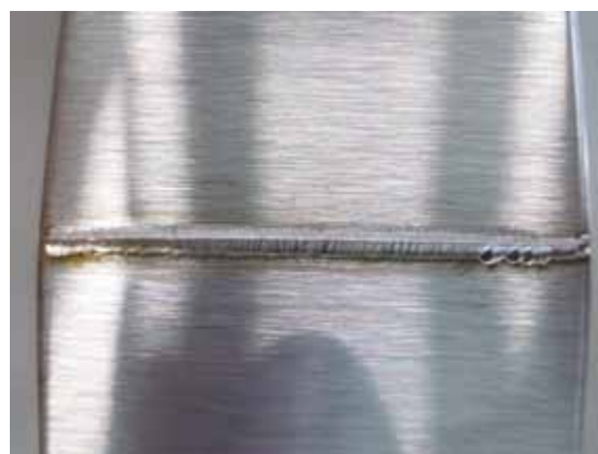
図 16 引張後の試験片 破断部拡大（20J 継手）
