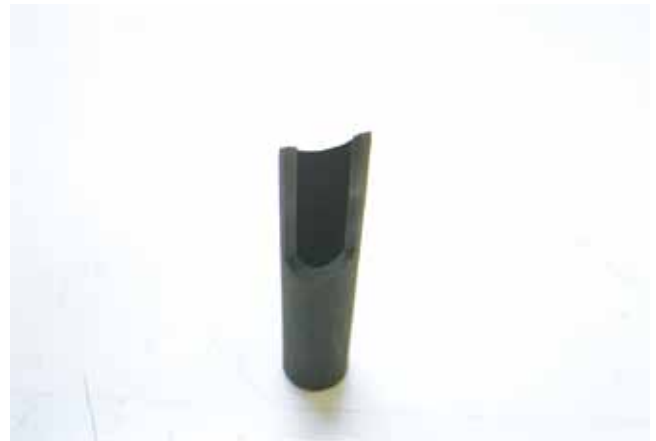
図10 角部面取り用 t1.5, t1.2 用チップ 正面イメージ
