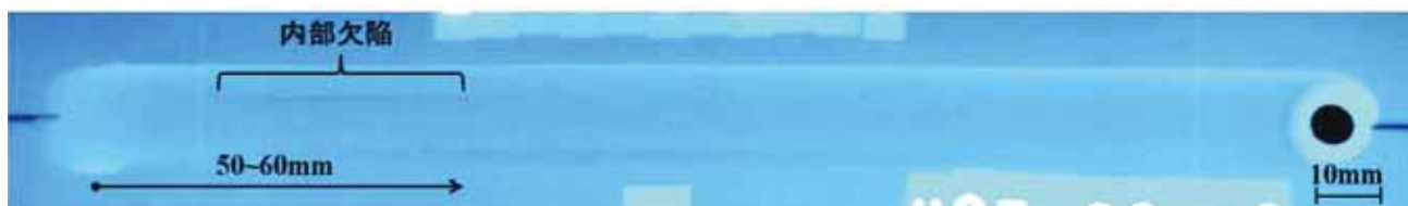
図4 No.2 継手の放射線透過試験の撮像
