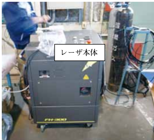
図1 ハンドトーチ型レーザー装置外観
