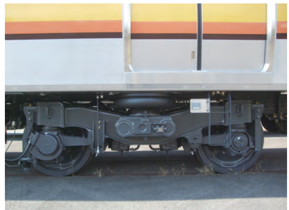
図10 TR255A 台車（レール塗油器付き）
