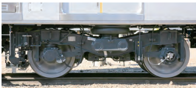
図9 付随台車（TR255D 台車）
