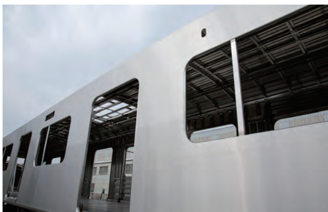
図1 レーザ溶接を適用した sustina 車両外観 (1)
