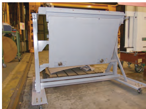
図2 側ふさぎ板の検証用モックアップ
