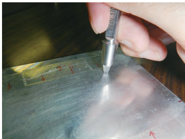
図6 ペン型探触子による探傷
