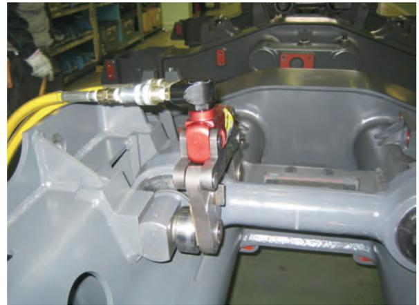
図3 一本リンク締付治具の開発
