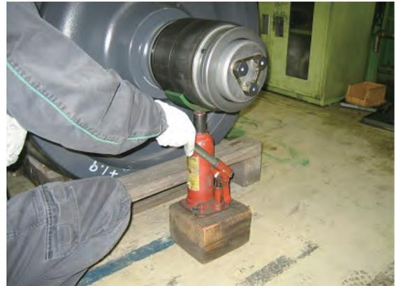
図8 ジャッキアップ作業(開発前)
