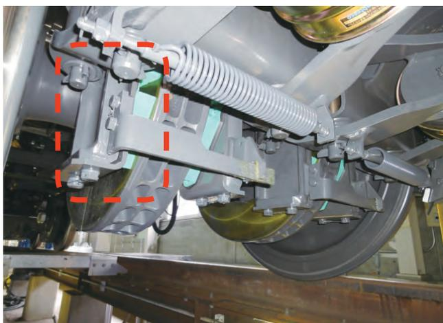
図7 現状のディスクブレーキ装置
