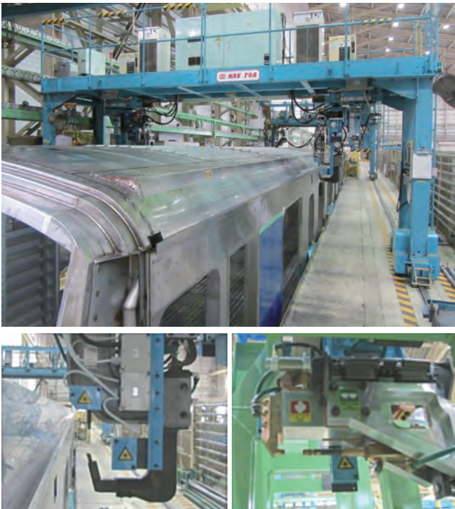
図9 側・屋根自動スポット溶接装置
