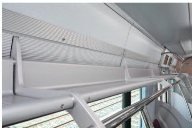
図11 荷棚上側天井用点検ふた（通常時）
