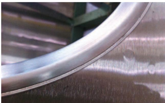
図8 レーザ溶接による窓枠部水密構造
