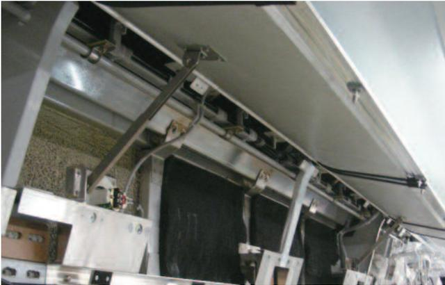
図12 荷棚上側天井用点検ふた（開放時）
