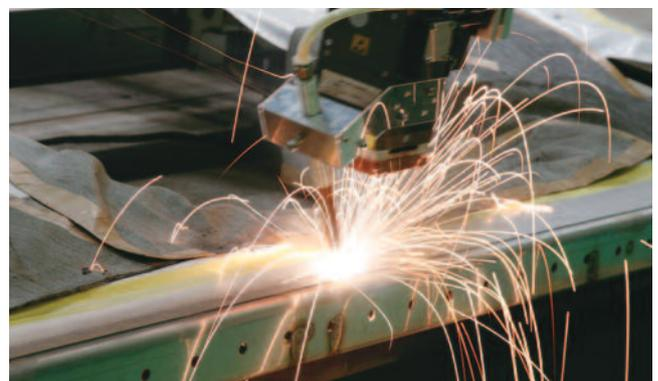
図7 レーザ連続水密溶接の様子
