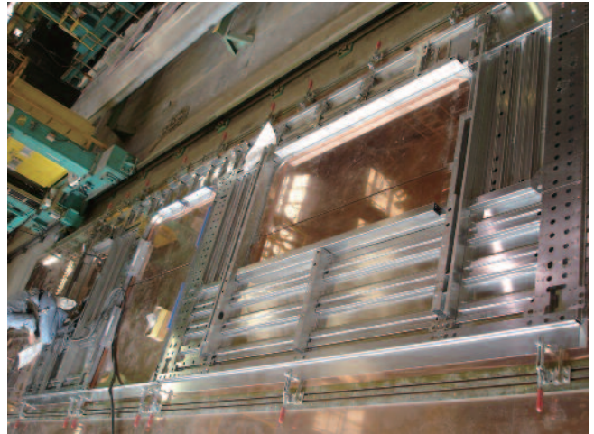
図3 銅板上の側構体の一部
