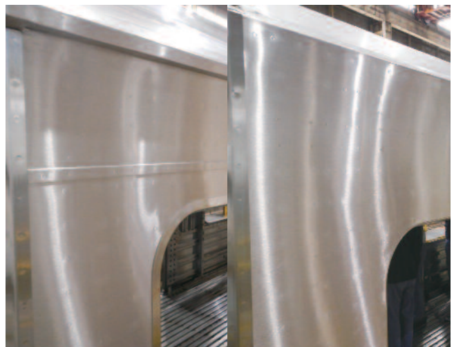
図5 構体圧痕外観写真(左：従来車, 右：「sustina」)
