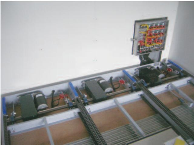
図4 電動モータおよび制御盤
