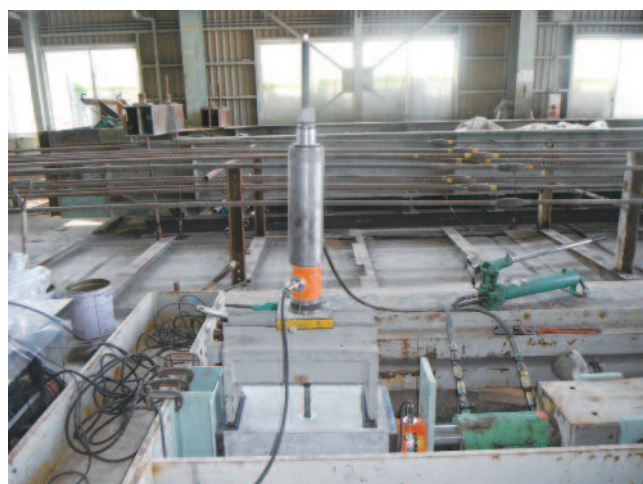
図4 引抜き強度確認試験
