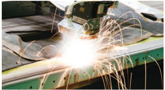
図9 レーザ重ね水密溶接の様子
