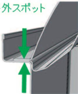
図1 側一屋根結合部（従来構造）
