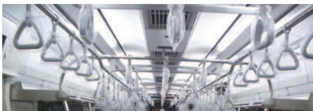
図25 LED間接照明による客室天井部の様子
