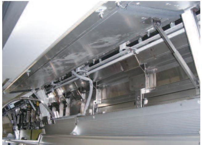
図18 側点検ふたパネル構造（開状態）
