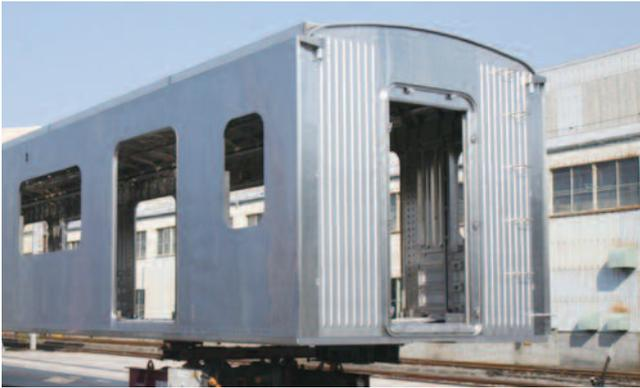
図13 試作車両のビード外板連結妻構体
