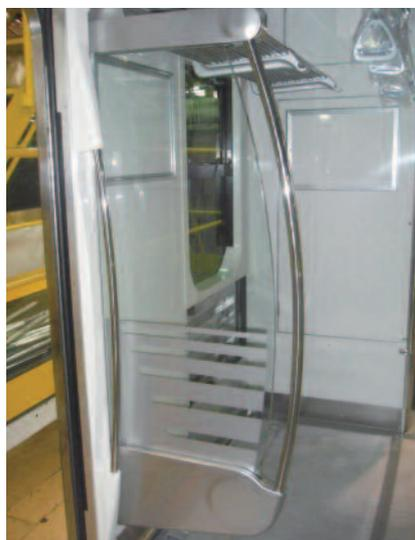
図26 ガラス製袖仕切構造と出入口きせ
