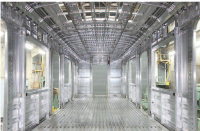
図14 試作車両構体内部
