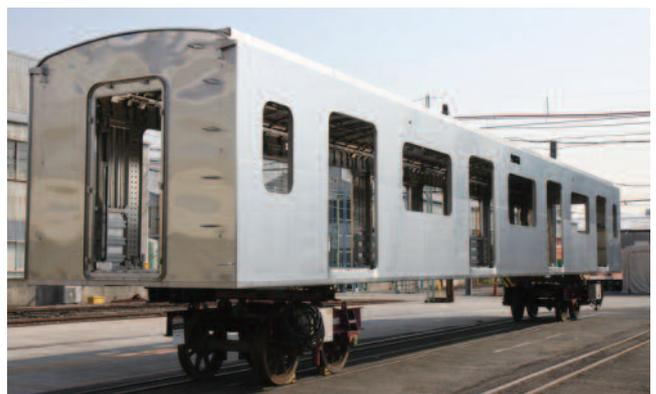
図12 試作車両の完成構体外観
