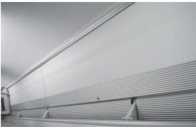
図17 側点検ふたパネル構造（閉状態）
