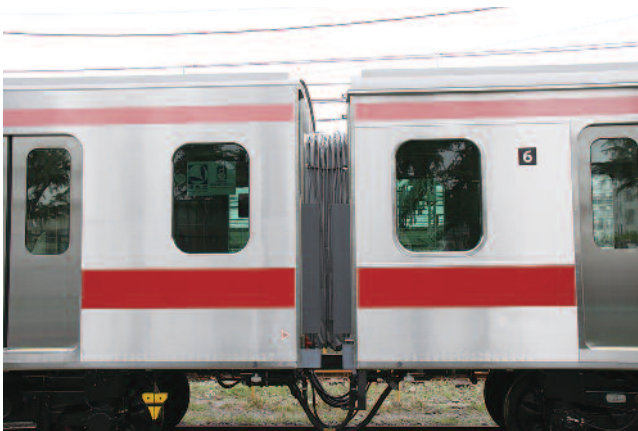
図3 車両外観の違い（左：新構造 右：従来構造）
