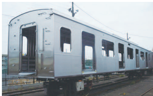
図11 （参考）従来構造の完成構体外観
