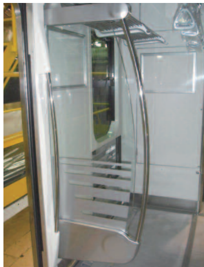
図26 ガラス製袖仕切構造と出入口きせ
