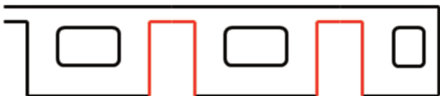
図8 側出入口周囲すみ肉溶接部（赤色部）
