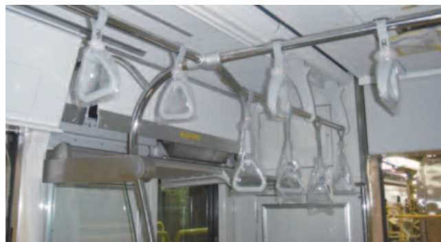
図20 内装ロールバー構造（部分）
