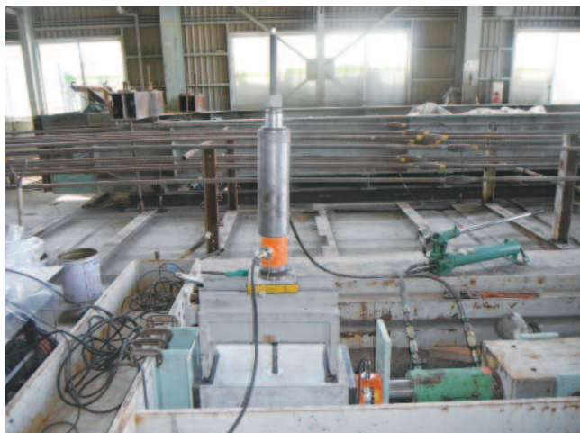
図4 引抜き強度確認試験
