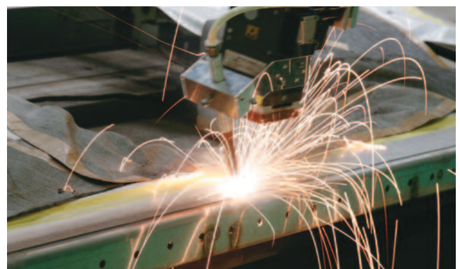
図7 レーザ連続水密溶接の様子
