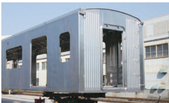
図13 試作車両のビード外板連結妻構体
