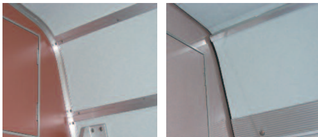
図1 妻部の押面構造（左）と目地構造（右）
