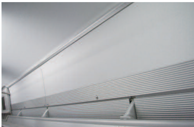
図17 側点検ふたパネル構造（閉状態）
