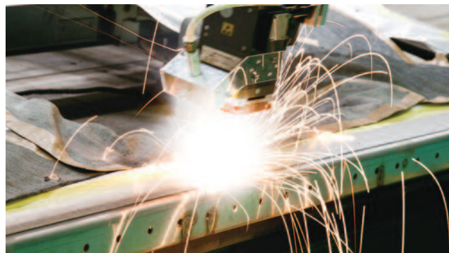
図9 レーザ重ね水密溶接の様子
