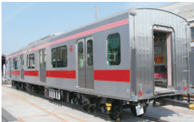
図27 完成した「sustina」第1号車両外観 （東急電鉄5050系5576号車）
