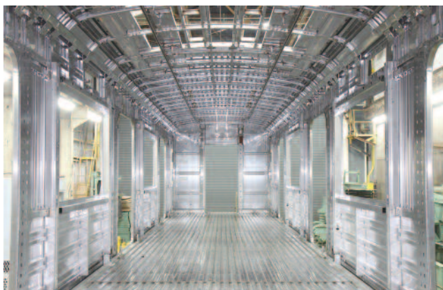
図14 試作車両構体内部
