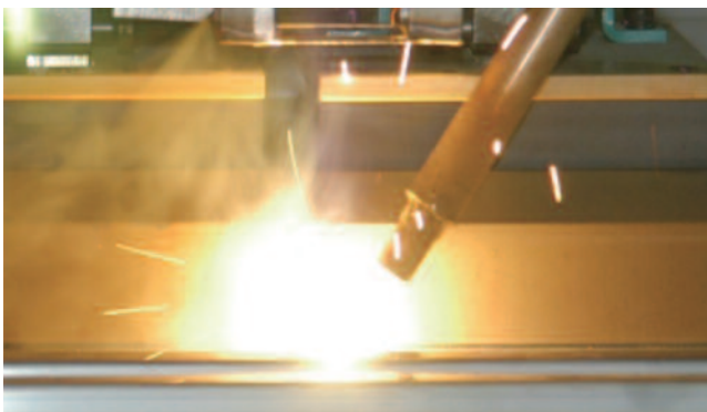
図6 レーザ突合せ溶接の様子
