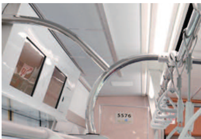
図9 内装ロールバー構造
