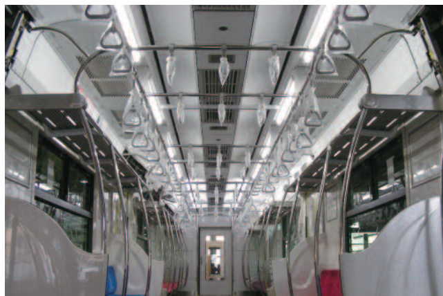
図19 内装ロールバー構造（全体）
