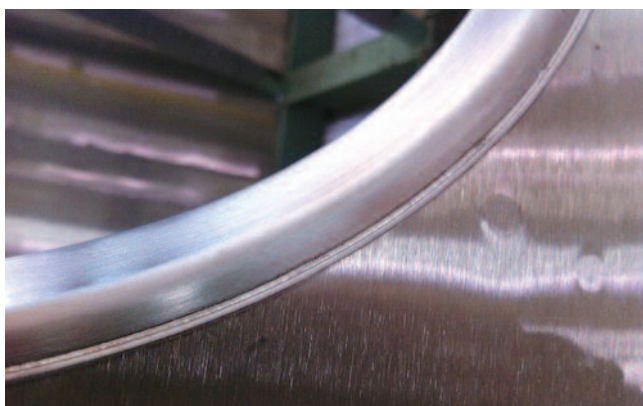
図8 レーザ溶接による窓枠部水密構造
