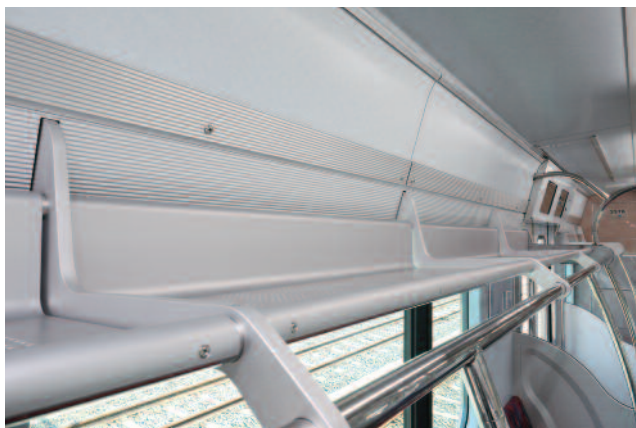
図11 荷棚上側天井用点検ふた（通常時）
