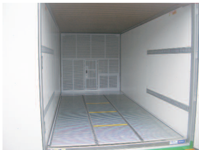
図3 オートフロア装置（荷物積み込み後状態）
