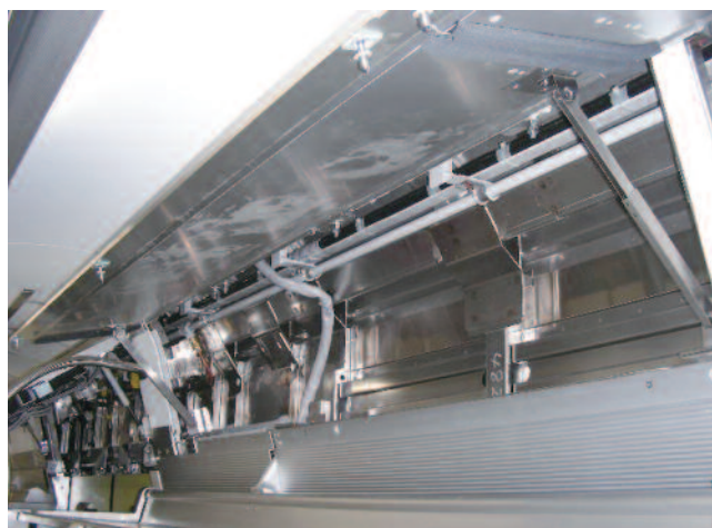
図18 側点検ふたパネル構造（開状態）
