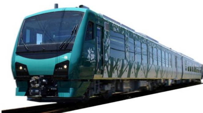
当社製造の最新ディーゼルハイブリッド車両 JR東日本向け リゾートしらかみ「撫」編成(HB-E300系) 【2016年7月よりJR五能線で営業運転開始】
