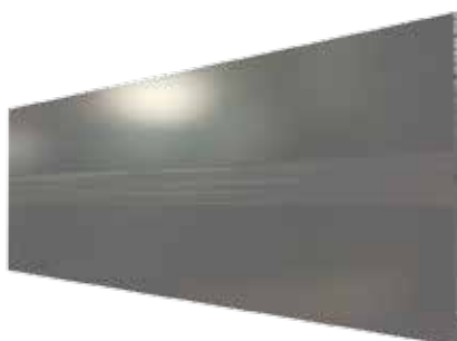
図 18 sustina フルフラット外板 (5) (外板のレーザ突合せ溶接)
