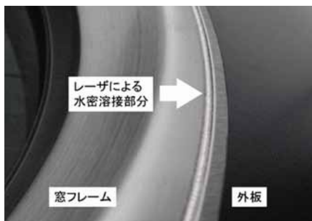
図 19 sustina 窓フレームと外板のレーザ溶接部分
