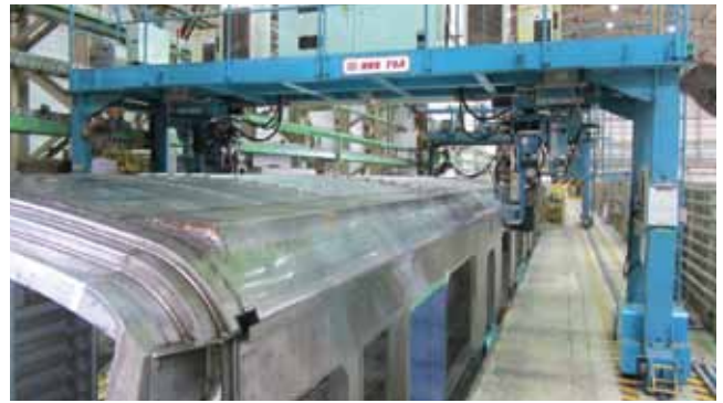
図17 側構体と屋根構体の自動溶接機 (6)
