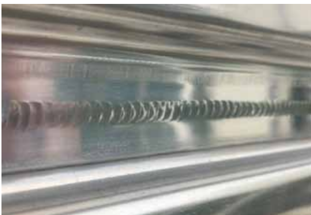
図 10 東急電鉄 7000 系のコルゲート板同士のシーム溶接部分
