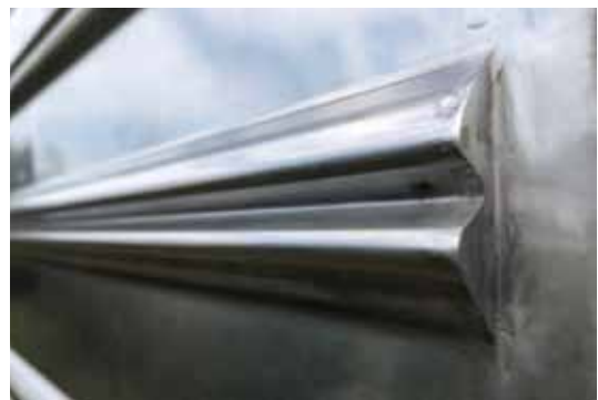
図4 東急電鉄5200系の端部処理をしたコルゲート外板
