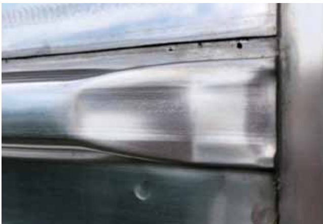
図 9 東急電鉄 7000 系のコルゲート板端部処理
