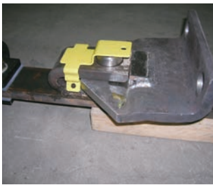
図5 脱落防止金具取付
