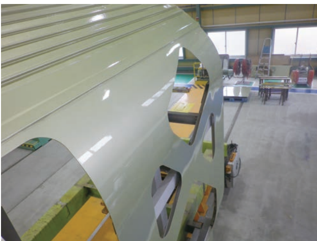
図10 車体モックアップによる塗装確認
