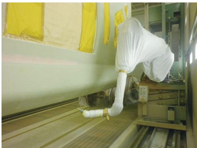
図6 モックアップを使用したロボット動作範囲確認
