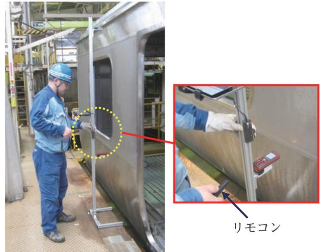
図6 開発品を用いた通り測定（腰板部測定時）
