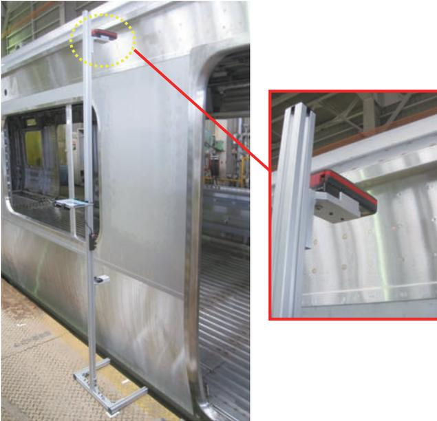
図4 測定装置（幕板部測定時）
