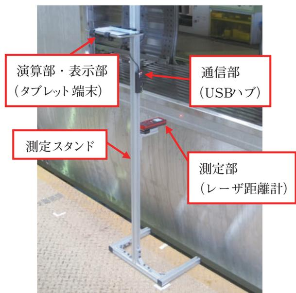
図3 測定装置（腰板部測定時）
