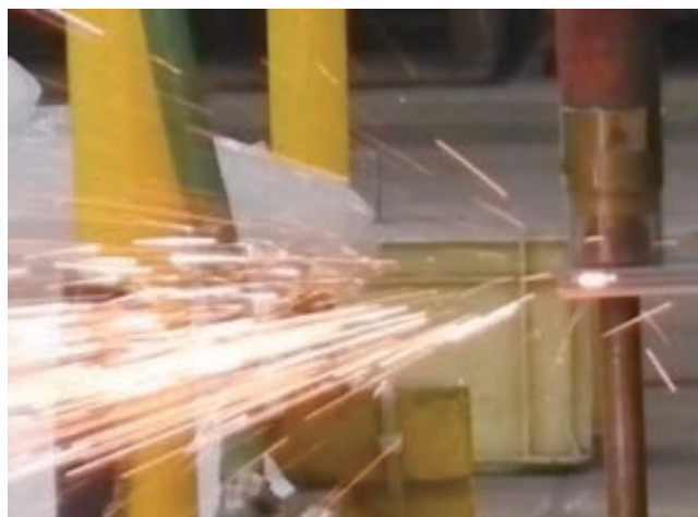
図2 抵抗スポット溶接のチリ
