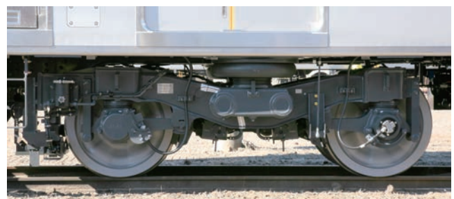
図 11 付随台車 (TR255D 台車) (1)
