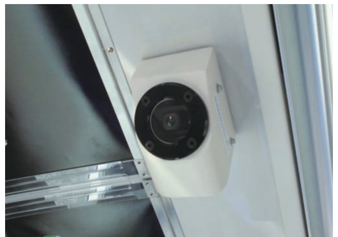
図3 室内防犯カメラ
