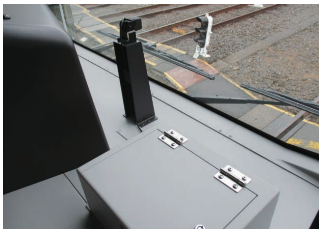
図5 前方監視カメラと記録装置
