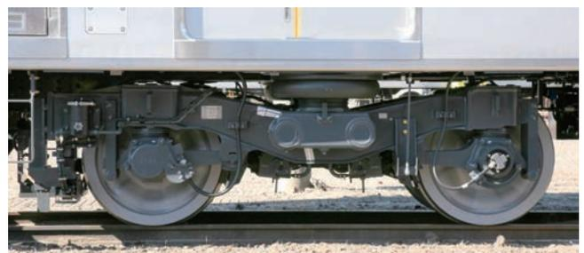
図11 付随台車 (TR255D 台車)<sup>(1)</sup>
