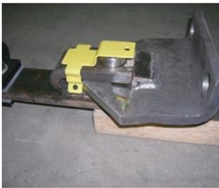
図5 脱落防止金具取付
