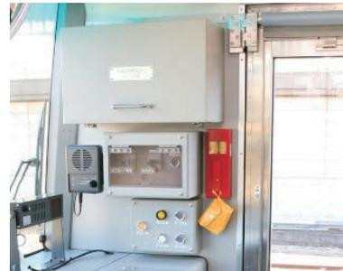
図9 架線認識異常扱いスイッチ箱<sup>(1)</sup>
