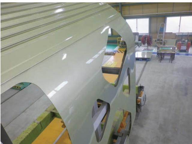
図10 車体モックアップによる塗装確認
