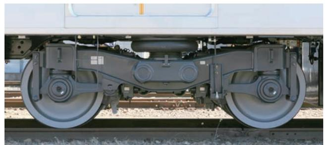
図10 電動台車 (DT79 台車)<sup>(1)</sup>
