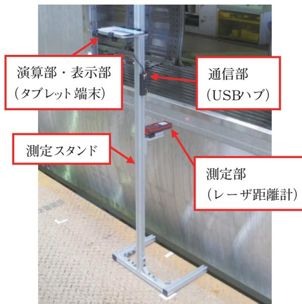
図3 測定装置（腰板部測定時）
