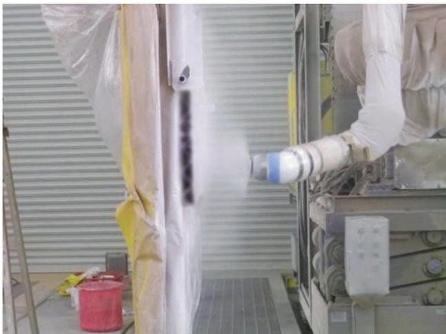
図1 ベル回転霧化式塗装ガン
