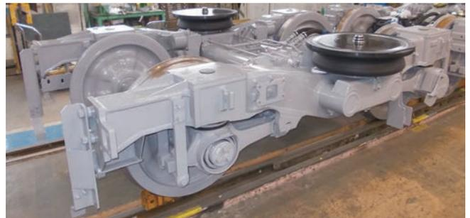
図12 TR260B 付随台車 (先頭台車)<sup>(1)</sup>
