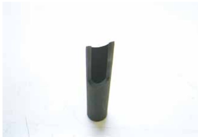
図10 角部面取り用 t1.5, t1.2 用チップ 正面イメージ
