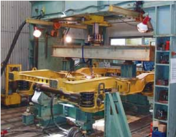
図 3 台車枠静荷重試験
