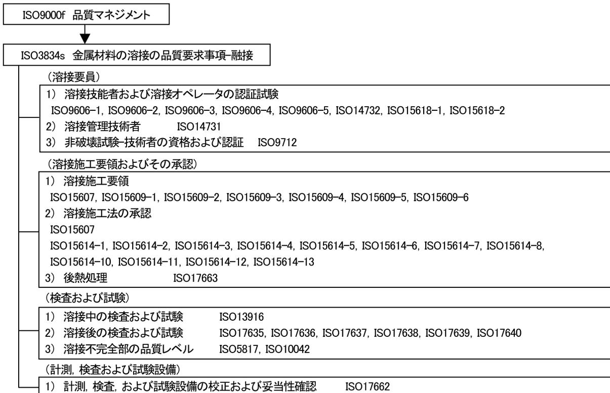
図2 溶接施工に関する ISO 規格体系
