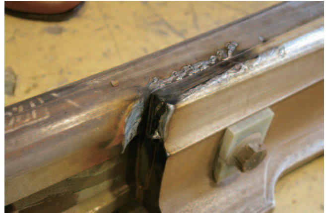
図4 アーク試験実施後のレール
