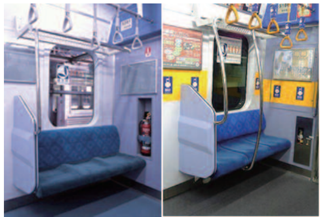
図9 以前の東急電鉄5000系優先席(左), UD手すりが増設された優先席(営業線投入後)(右)
