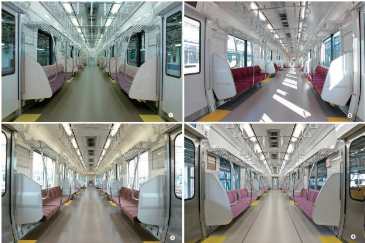
図11 UD手すりを採用した一例、上段から①小田急電鉄4000系②相模鉄道11000系③南海電鉄8000系④京王電鉄1000系5次車
