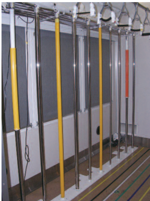
図8 9種類の縦手すりが並ぶ実験装置 (左から3本目がφ35ディンプル付き手すり)
