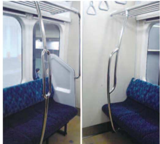
図7 複数の立位客が利用できる手すり(左)、立位客と座位客の把持部を分けた手すり(右)
