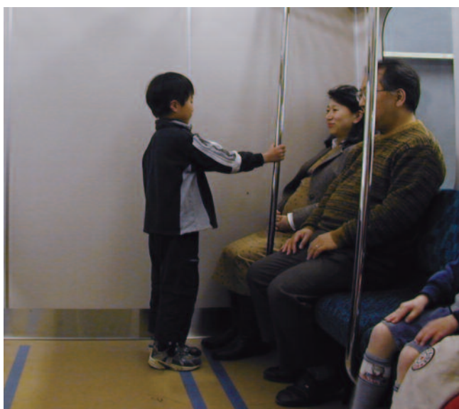
図3 従来手すりに掴まる子供 （座席前縁250mmのラインを踏んでいる）
