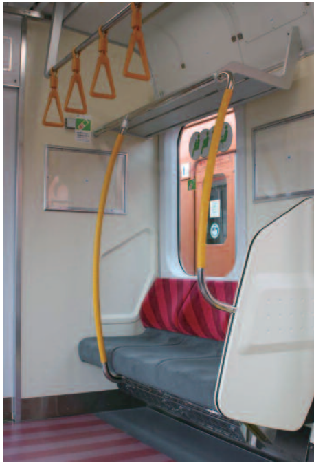
図10 JR東日本E233系に設置した、黄色に識別化されたディンプル付きUD手すり
